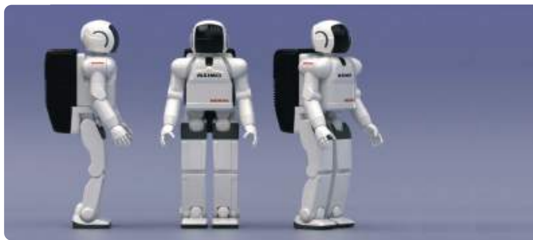
Asimo, um robô bípede com aspecto humanoide construído pela Honda.
